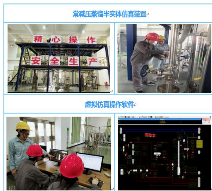
图 2 常减压蒸馏半实体仿真软件及装置
