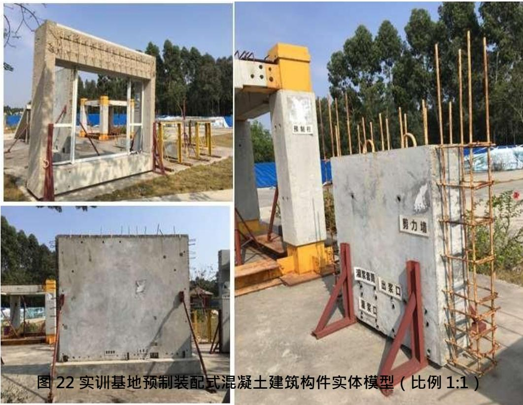
图 22 实训基地预制装配式混凝土建筑构件实体模型（比例 1:1）
