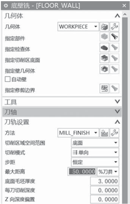
图 2-1-11 底壁铣参数设置
