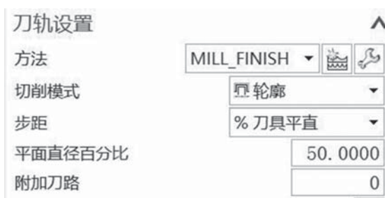
图 2-2-30 刀轨参数设置
