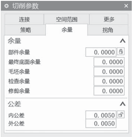
图 2-2-32 切削参数设置
