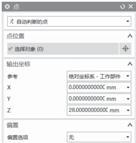
图 2-1-46 加工原点设置
