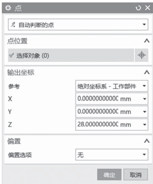
图 2-1-5 加工原点的设置
