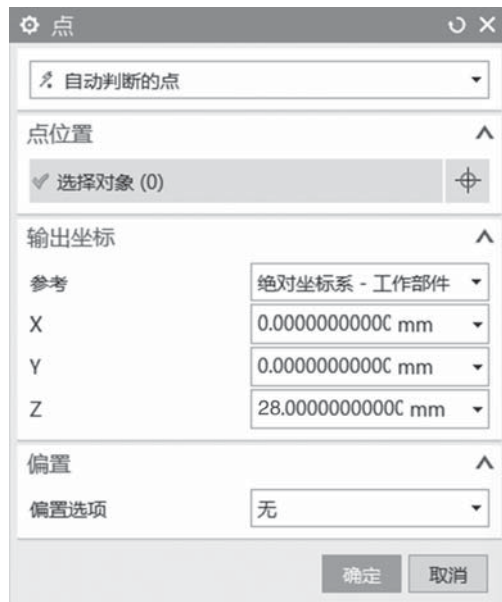
图 2-1-19 加工原点的设置
