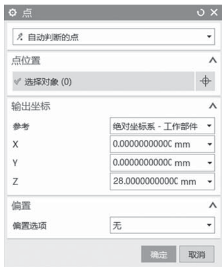
图 2-1-33 加工原点的设置
