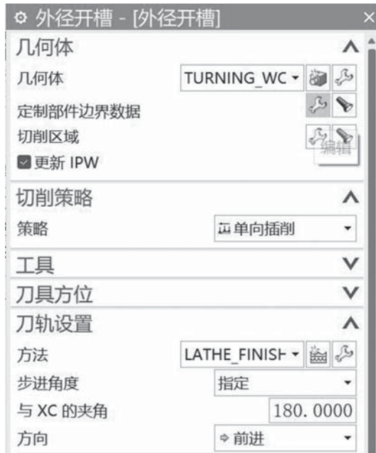
图 5-1-49 外径开槽界面
