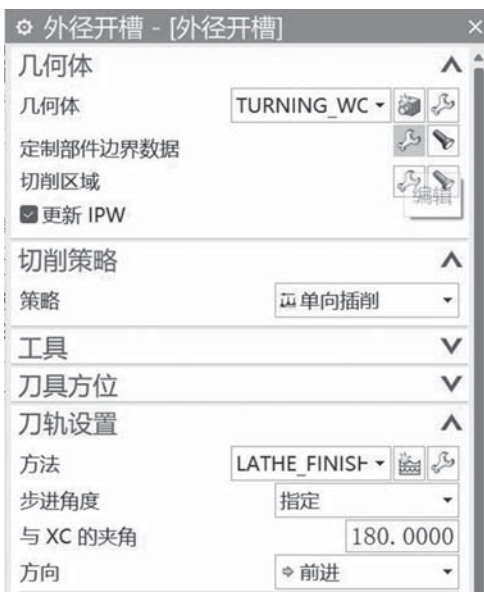
图 5-2-33 外径开槽界面
