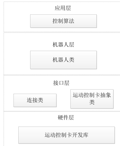
图8 四层运动控制器软件系统
